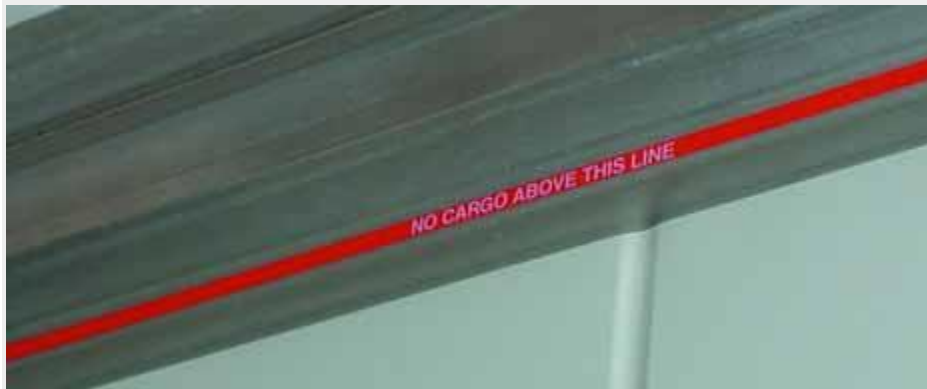
Chiều cao đóng hàng tối đa trong container được đánh dấu bằng đường kẻ đỏ
